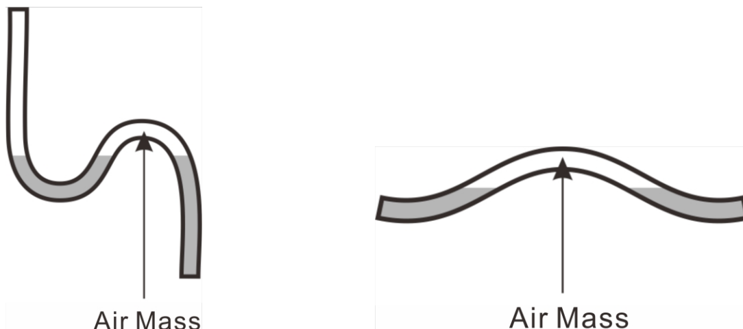
Рис. 3 Неправильні способи підключення труб
