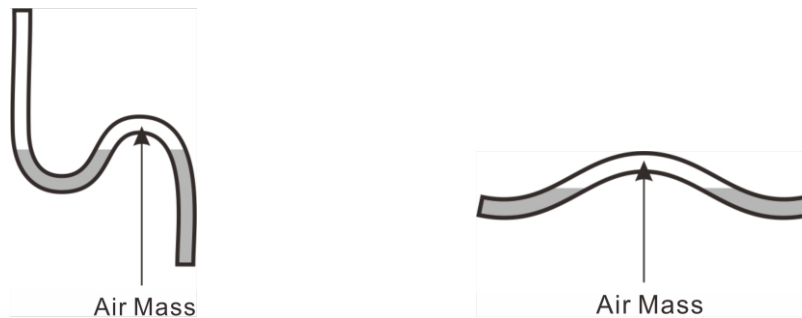
Рис. 6 – Неправильне підключення труб
