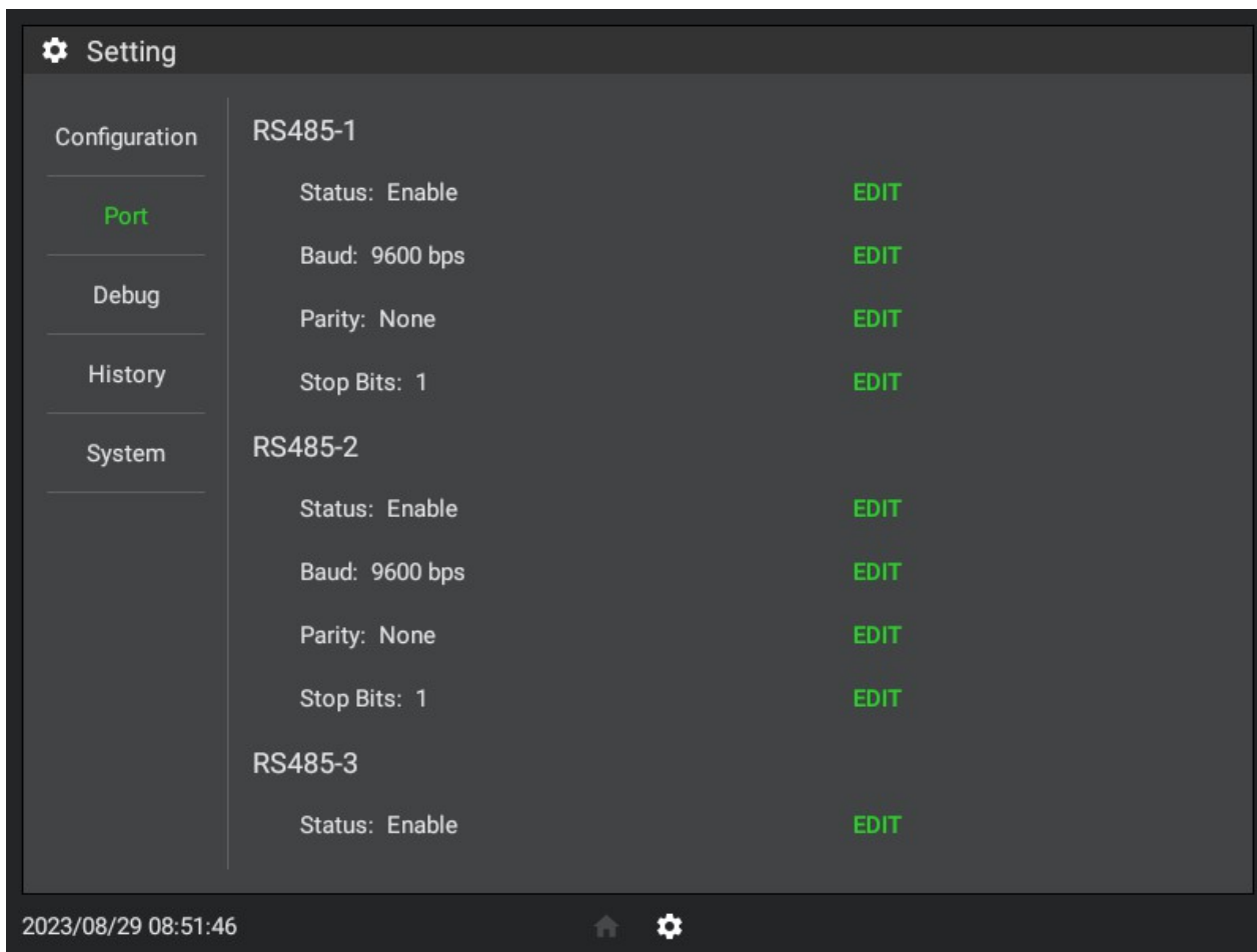
Рис. 5 Налаштування портів (сенсорний екран)
