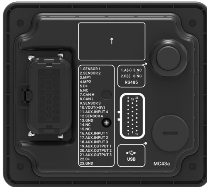
Рис. 1 Задня панель НМС4300
