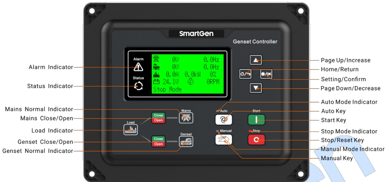
Рис. 1 Індикатори на передній панелі HGME62 (HGME62/CAN)
