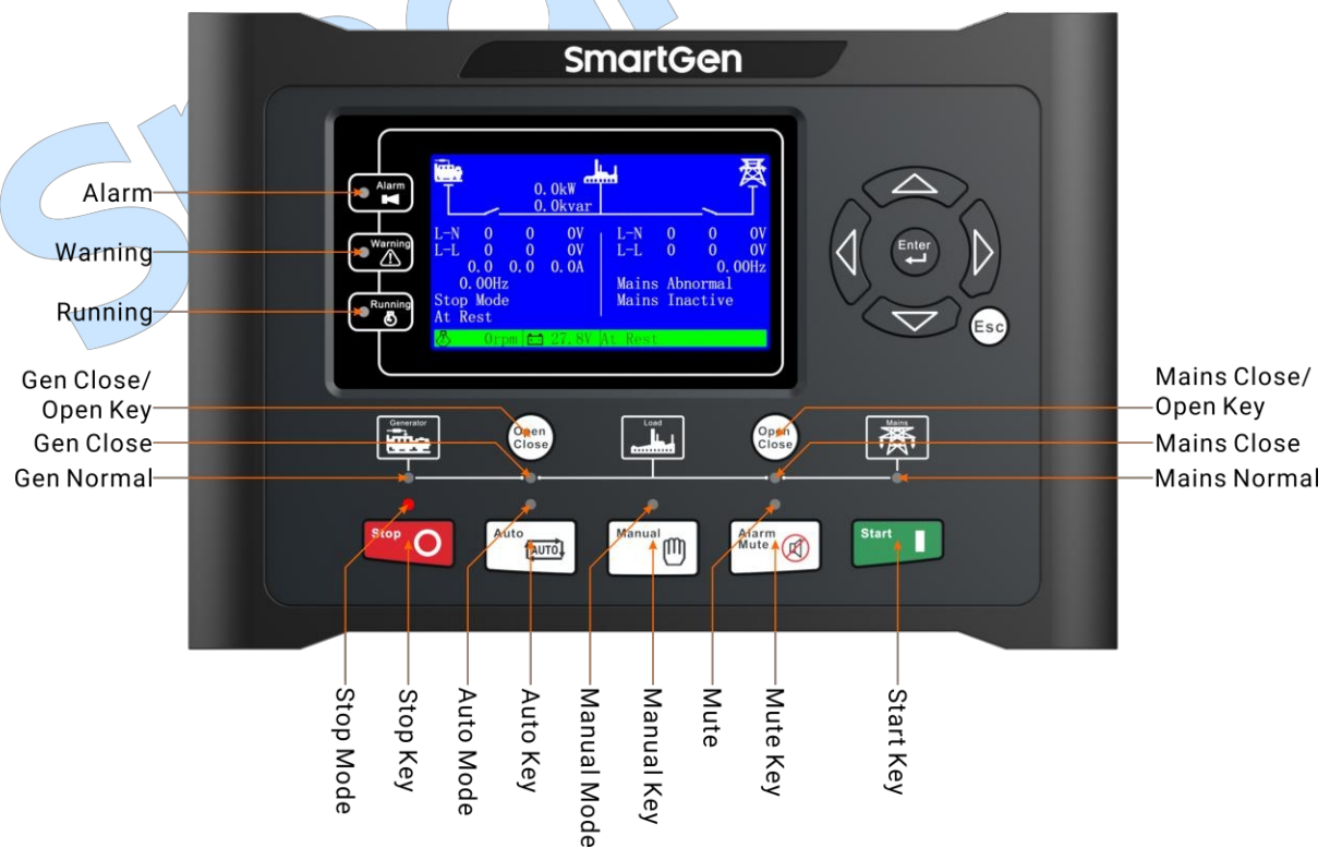
Рис. 2 Передня панель HGM9620
