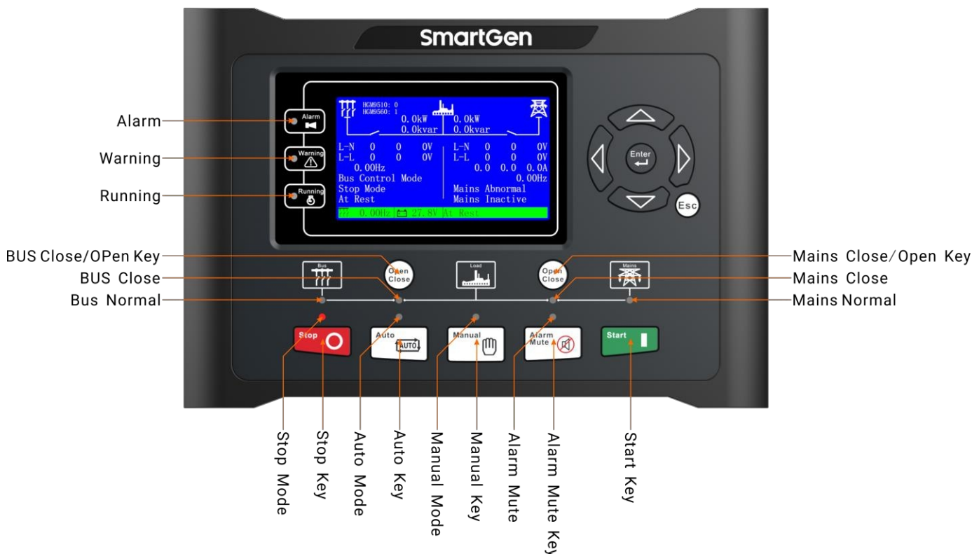
Рис. 1 Передня панель HGM9560
