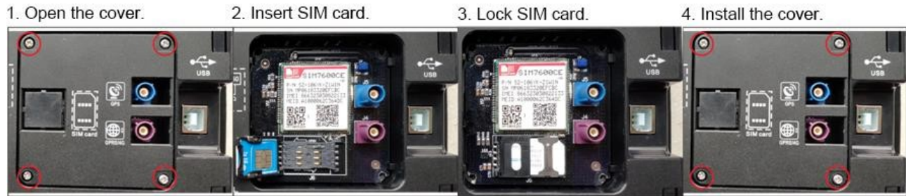
Рис. 14 Спосіб встановлення SIM-карти
