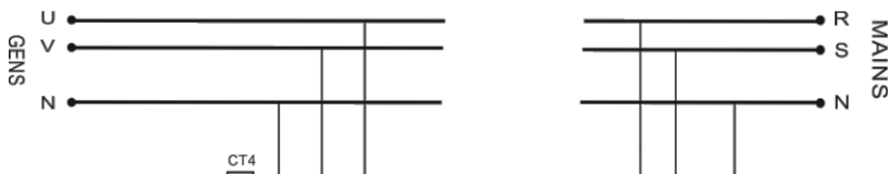
Рис. 8 Схема однофазного 2-проводного підключення
