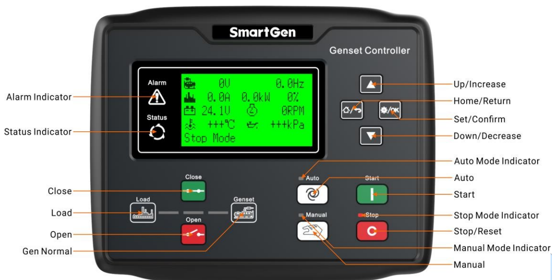
Рис. 1 — Індикація на передній панелі HGM6110LT
