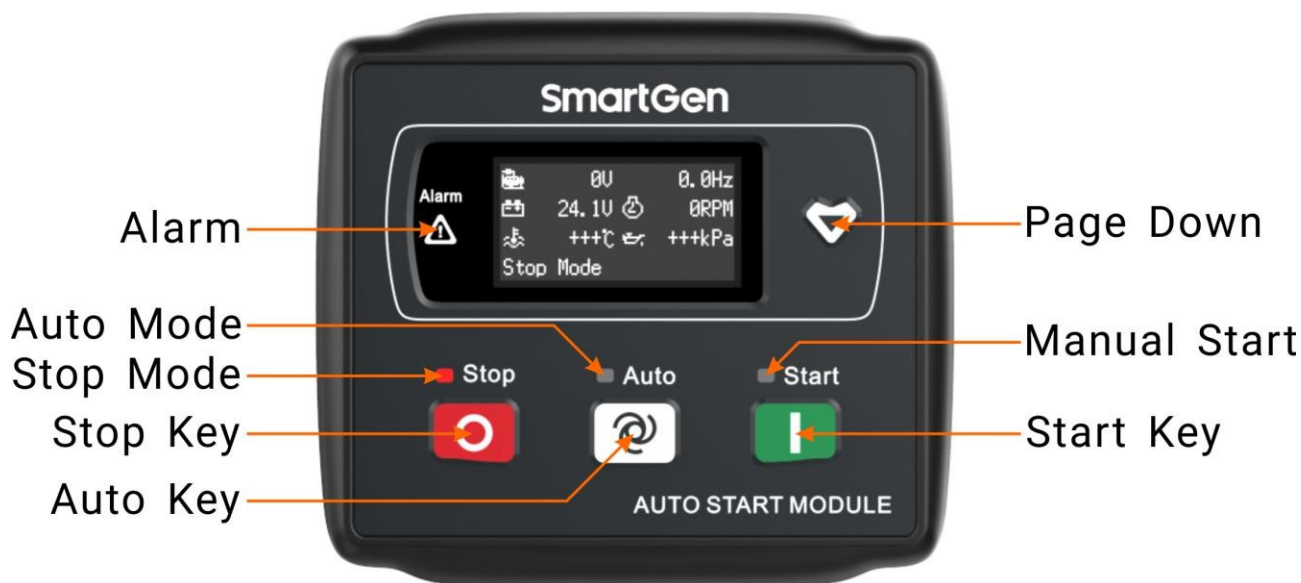
Рис. 1. Передня панель HGM1791LT_HGM1791LT-CAN
