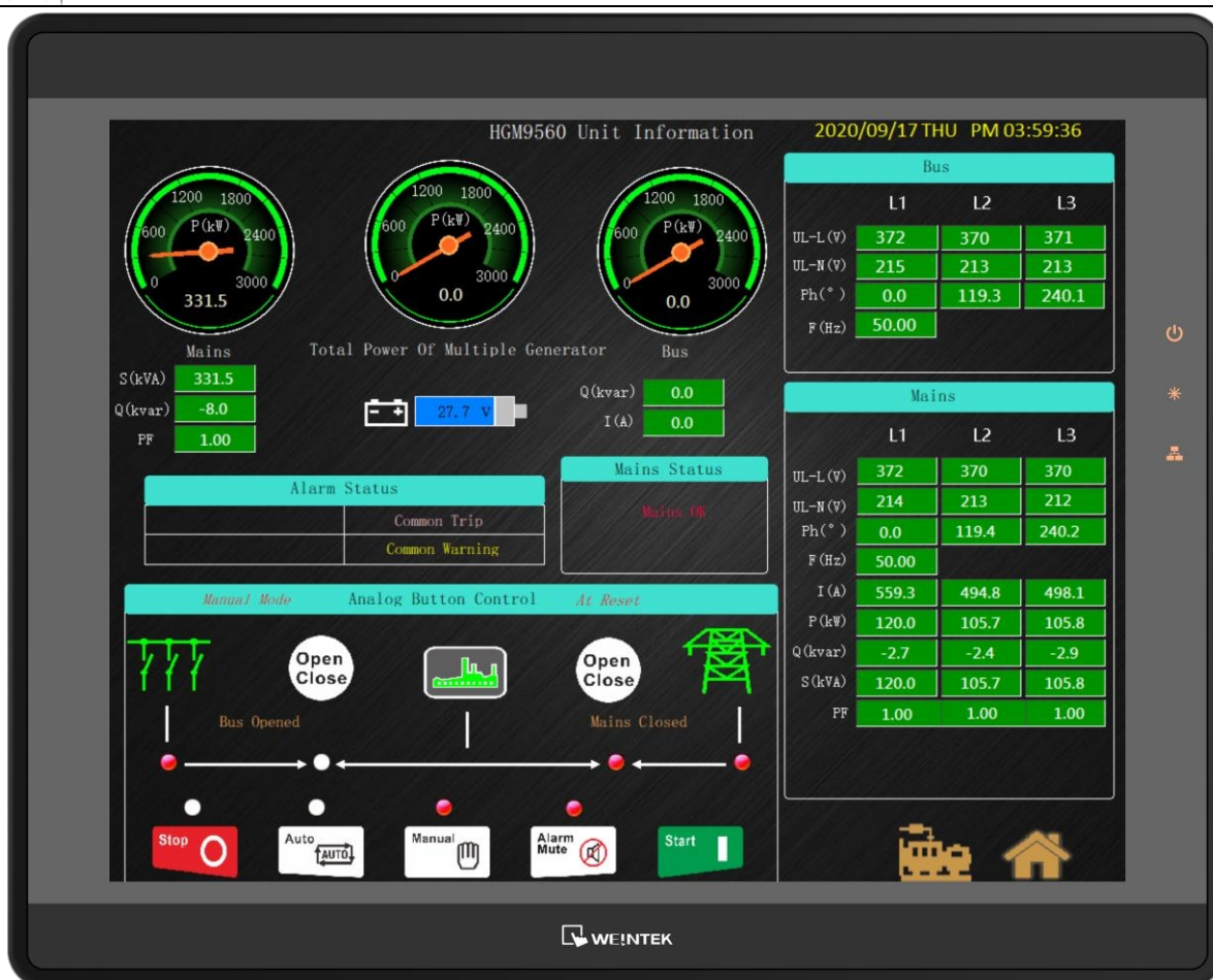
Рис. 3 – Екран з інформацією про генераторну установку HGM9560
