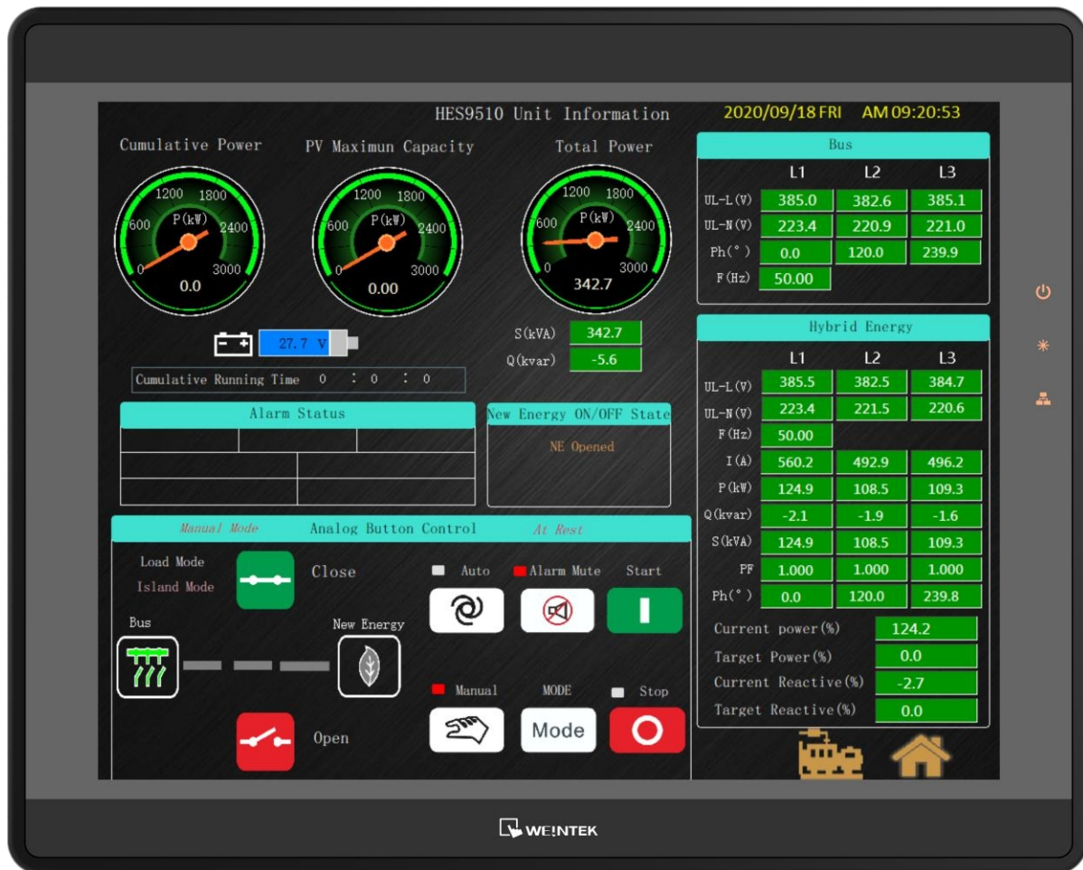
Рис. 4 - Інформація про генераторну установку HES9510 на дисплеї контролера
