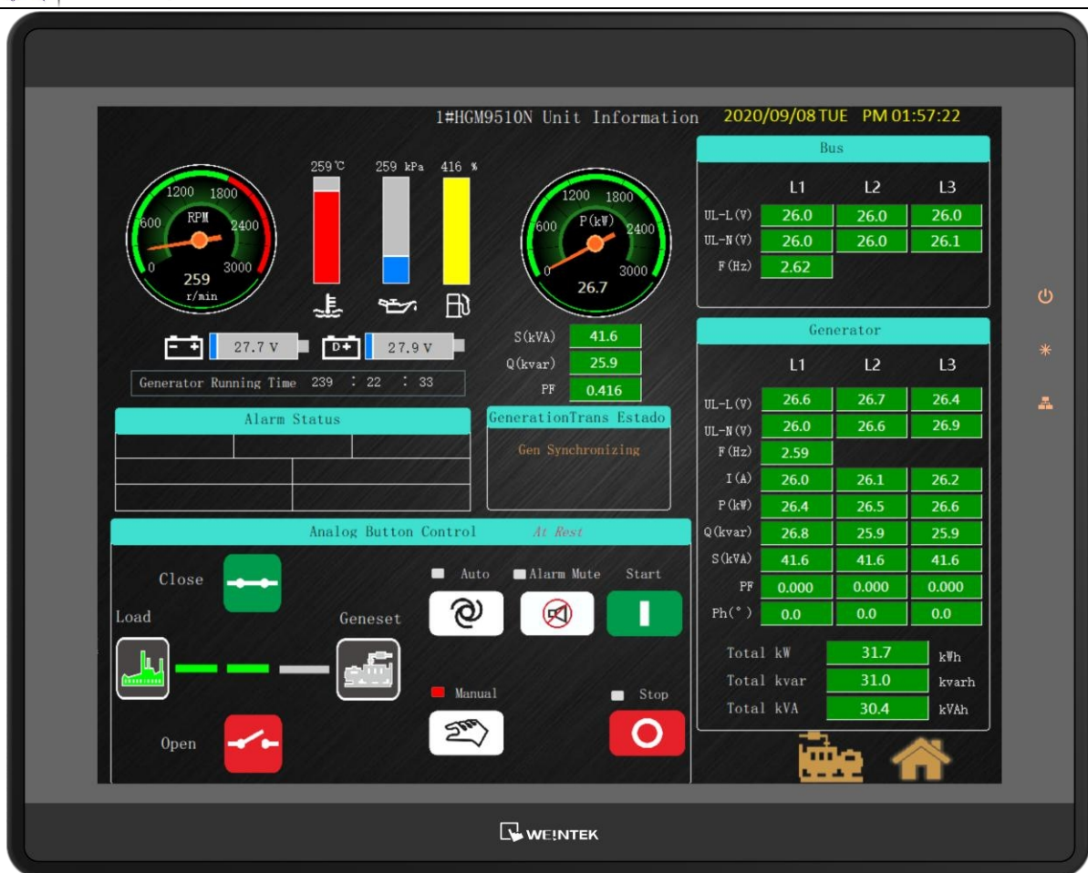
Рис. 2 – Дисплей інформації про окрему електростанцію HGM9510N
