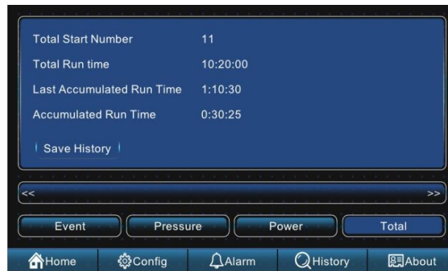
Рис. 18. Сторінка «Загальні дані» про роботу двигуна пожежного насоса
