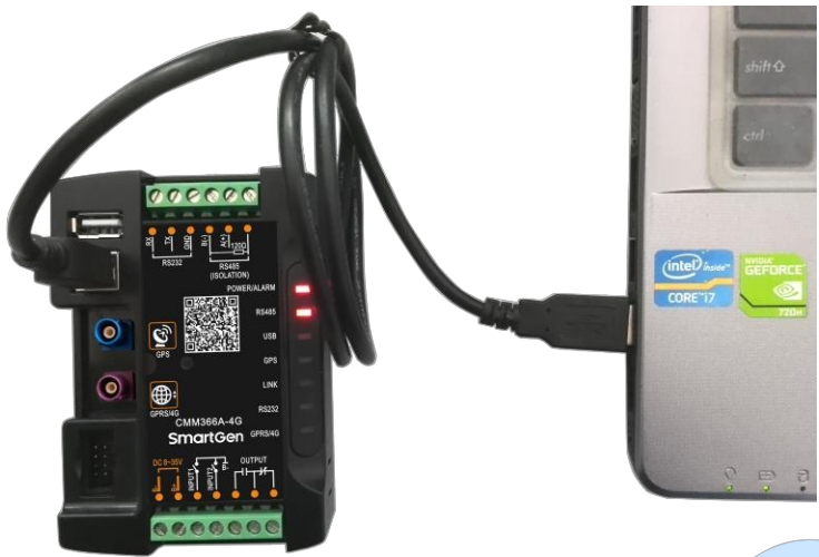
Рис. 9 Підключення USB до ПК
