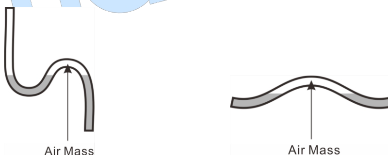
Рис. 6 – Неправильні способи підключення труб
