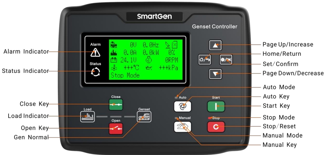
Рис. 1 - HGM6110-4G (HGM6110N-4G/CAN-4G) Індикація на передній панелі
