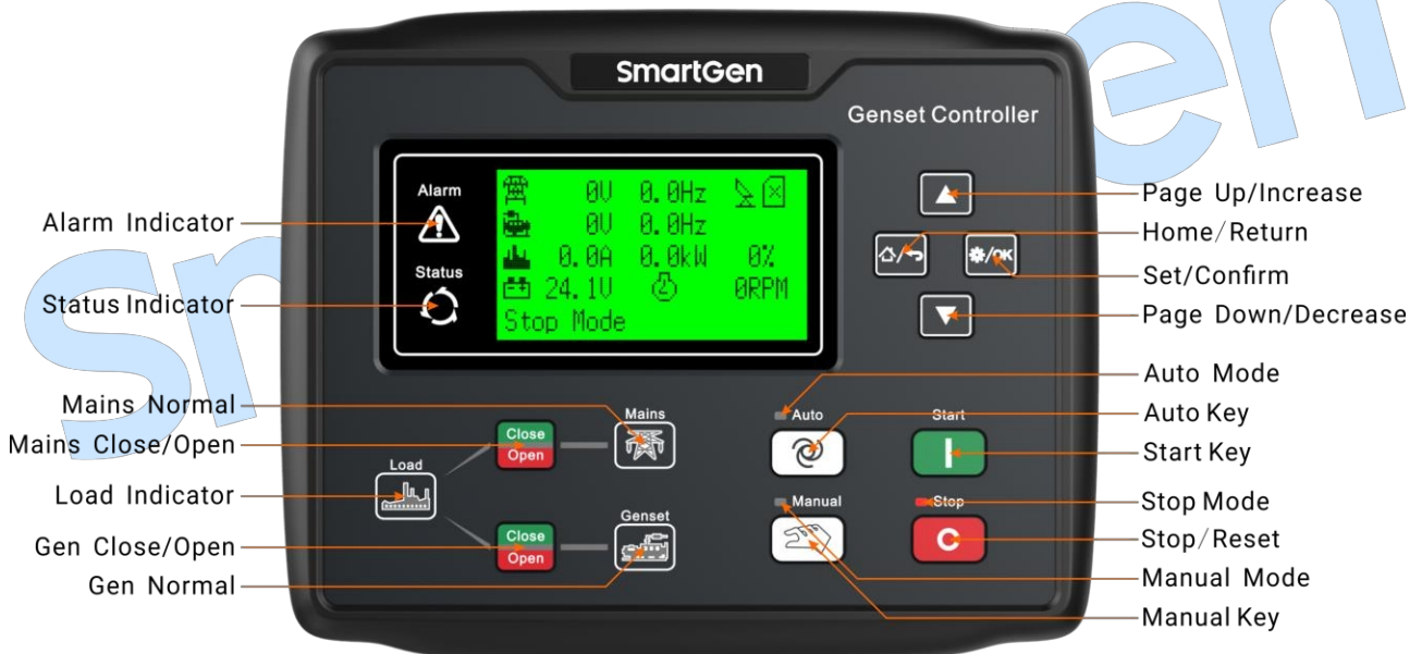
Рис. 2 - HGM6120-4G (HGM6120N-4G/CAN-4G) Індикація на передній панелі
